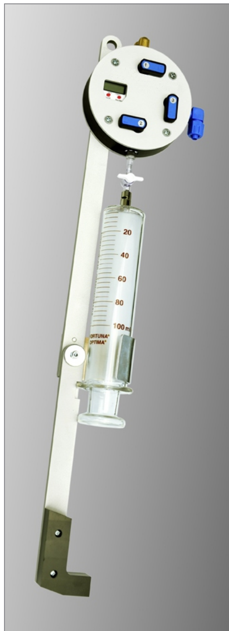
Handprobennahme mit Glasspritze (100 mL)
